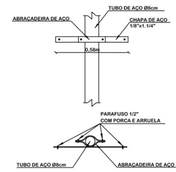
DETALHE DE FIXAÇÃO AO SOLO PARA PLACAS DE REGULAMENTAÇÃO E ADVERTÊNCIA 0,60x0,20x0,20m
