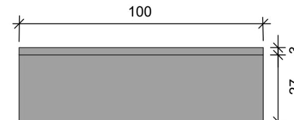
DETALHE MEIO FIO - ELEVÇÃO FRONTAL Sem Escala
